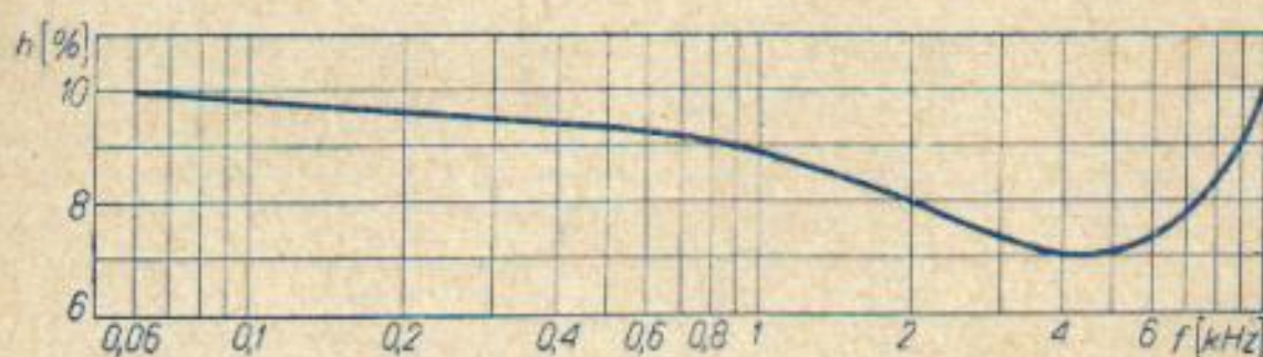
Zależność współczynnika zawartości harmoniczných od częstotliwości sygnału
