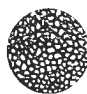
Schets van de doorsnede van een ijzerkern, die uit ijzerpoeder bestaat. Deze kern wordt gebruikt voor H.F. spoelen.
