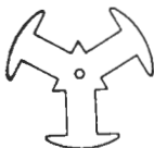
Voorbeeld van een stervormig anker, waardoor de motor minder stotend loopt.
