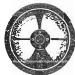
Voorstelling van de schaduw- en lichtsectoren op het scherm van de EM34.
