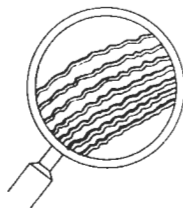
Vergroot beeld van de groeven in een gramfoonplaat.
