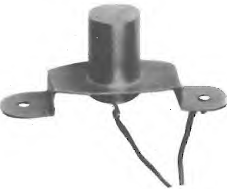
Fig. 3 - Organo sensibile alla temperatura costituito da un resistore a coefficiente di temperatura negativo, incapsulato in un tubetto di rame.
