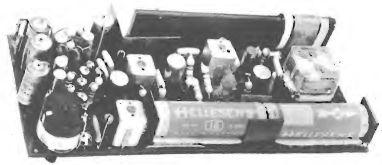
Fig. 2 - Realizzazione sperimentale del circuito a sette transistor.
