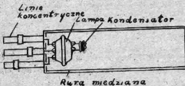
Rys. 4 Konstrukcja generatora 3000 megacykli z trioda
