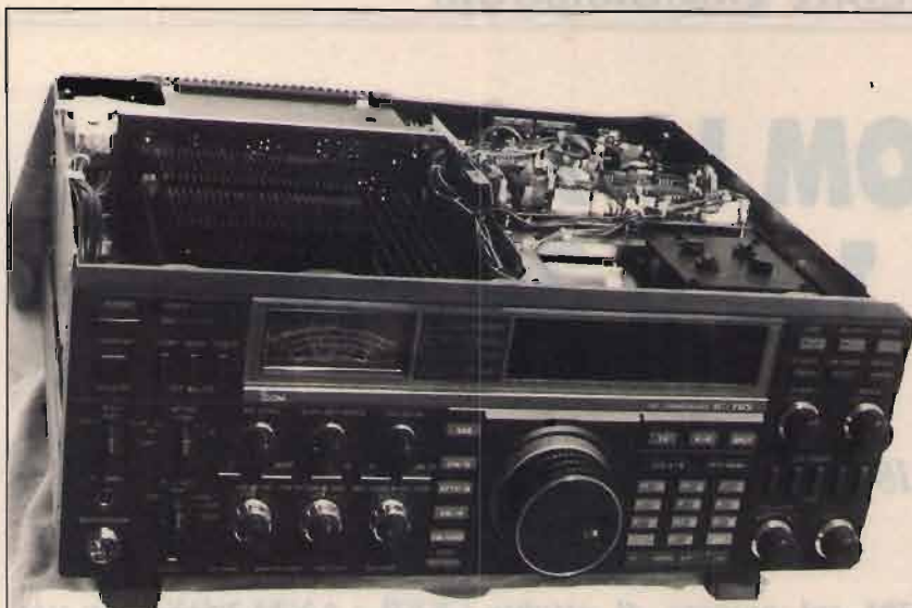
foto 2 Vista dell'IC-765 dopo aver tolto il coperchio superiore.
