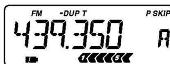
**Esempio di indicazione:** ricevitore predisposto su 439.350 MHz
