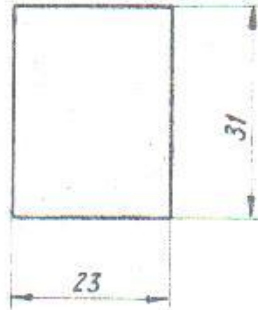
Rys. 13 Wymiary otworu pod wyciącznik.
