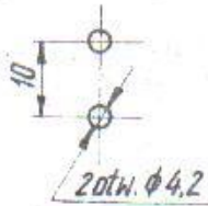
Rys.3 Rozmieszczenie otworów mocujących zaczepek 06320/1 do mikrofonu 0171/5 oraz 0178/1
