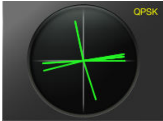
Sintonía correcta (Modo de QPSK)
