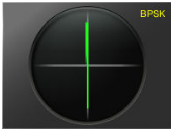
Sintonía correcta (Modo de BPSK)
