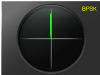
Señal de portadora no modulada
