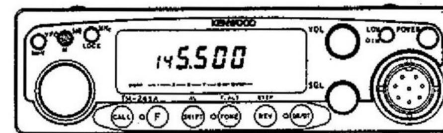
Se l'indicatore F si spegne, è necessario premere di nuovo il tasto F per completare la selezione. Dopo la pressione del tasto MR/M l'indicatore F e il numero di canale di memoria si spengono e il ricetrasmittitore ritorna al modo VFO.
