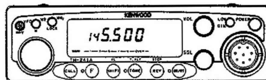
4. La frequenza può essere modificata tramite il comando di sintonia o i tasti UP/DWN sul microfono.
