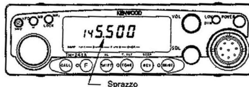
6. La ricerca comincia in direzione ascendente. Si può invertire la direzione ruotando il comando di sintonia in senso antiorario, o premendo gli interruttori UP / DWN del microfono. L'entità del passo di ricerca dipende dall'attuale programmazione del passo di frequenza.
