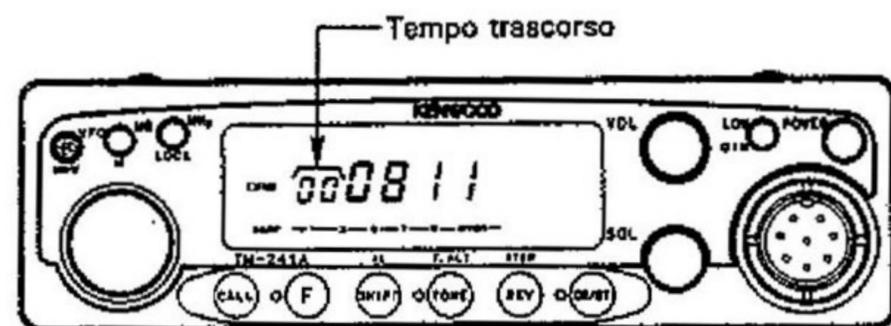
4. La registrazione si arresterà quando l'indicatore del tempo arriva al valore "0". Per continuare la registrazione, ruotate il controllo della sintonizzazione al successivo numero di frasi e premete quindi il tasto VFO nuovamente. La registrazione si arresterà alla pressione di qualsiasi tasto sul pannello anteriore.
