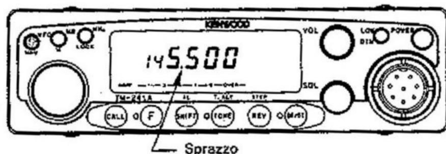
4. La scansione verso l'alto avrà inizio. Potete invertire la direzione della scansione girando il controllo della sintonizzazione nel senso antiorario o premendo l'interruttore DWN sul microfono. La rotazione del controllo di sintonizzazione nel senso orario oppure la pressione dell'interruttore UP causerà la scansione verso l'alto della radio. La misura dei passi di scansione dipende dalla attuale selezione del passo (STEP).
