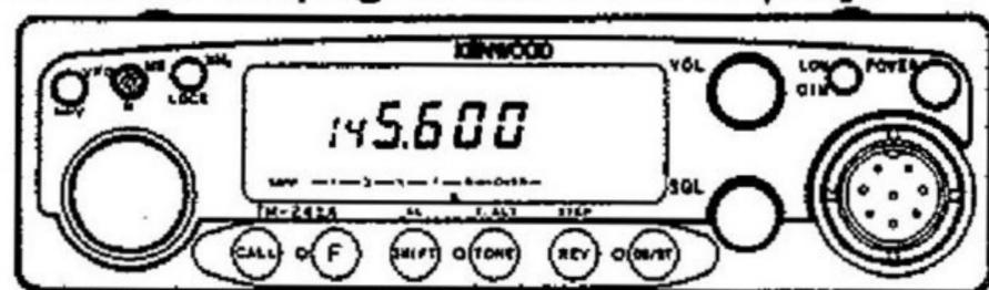
6. Entro 10 secondi dalla pressione del tasto MR selezionare la frequenza di trasmissione usando il comando di sintonia o gli interruttori UP/DWN del microfono.
