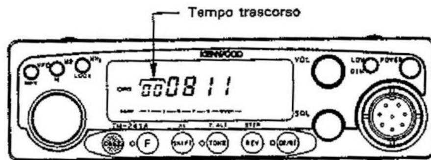
3. La riproduzione si arresterà quando l'indicatore del tempo visualizza il valore "00". Potete far arrestare la riproduzione manualmente premendo qualsiasi tasto sul pannello anteriore.
