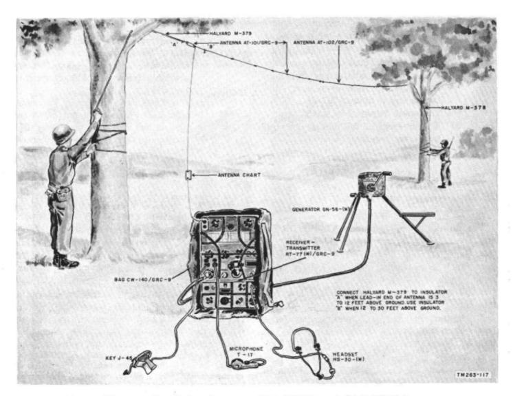
Figure 19. Installation of antennas AT-101/GRC-9 and AT-102/GRC-9.
