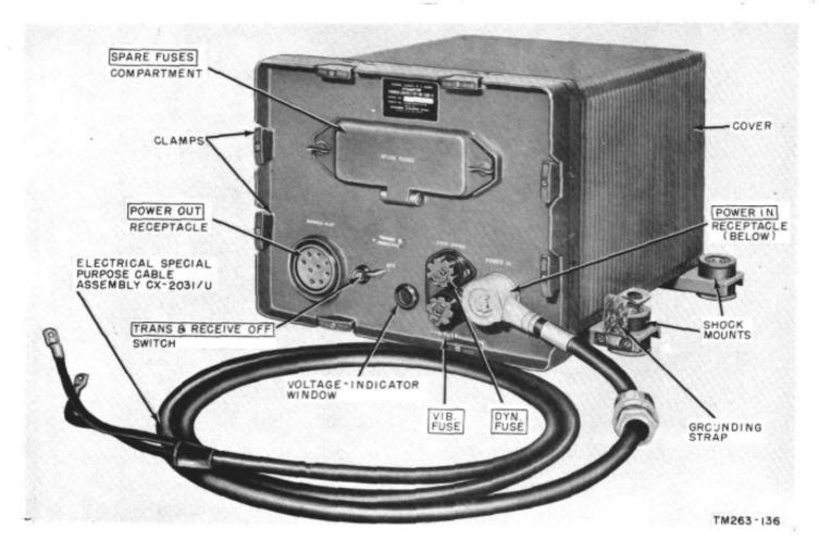
Figure 11. Dynamotor-Power Supply DY-88/GRC-9.
