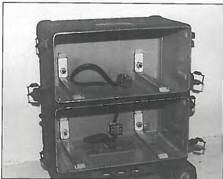
Interno del cofano. In alto la parte riservata al ricevitore, in basso quella dell'alimentatore
