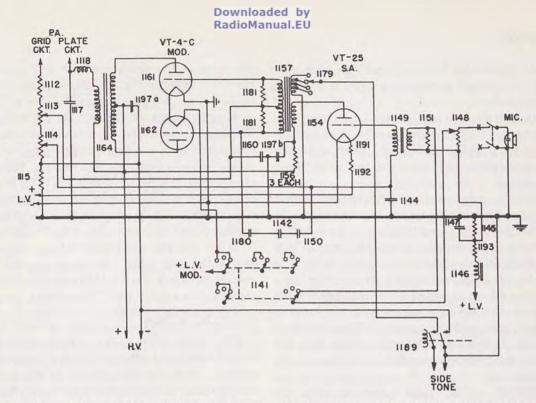
FIG. 15. RADIO TRANSMITTER BC-375-D, FUNCTIONAL DIAGRAM OF AUDIO-FREQUENCY CIRCUITS-VOICE OPERATION
