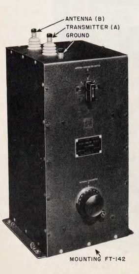
FIG. 2. ANTENNA TUNING UNIT BC-306-A
