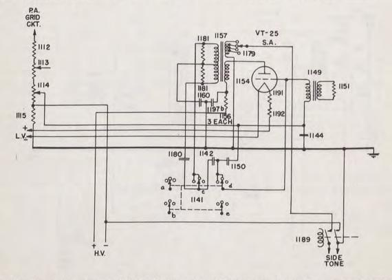
FIG. 14. RADIO TRANSMITTER BC-375-D, FUNCTIONAL DIAGRAM OF AUDIO-FREQUENCY CIRCUITS-CW OPERATION (SIDE TONE)
