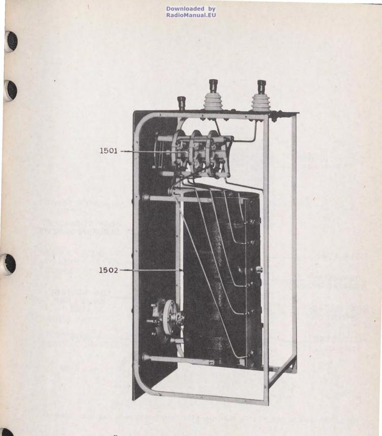
FIG. 21. ANTENNA TUNING UNIT BC-306-A, INTERIOR VIEW
