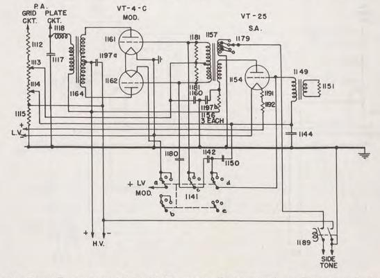
FIG. 13. RADIO TRANSMITTER BC-375-D, FUNCTIONAL DIAGRAM OF AUDIO-FREQUENCY CIRCUITS-TONE OPERATION
