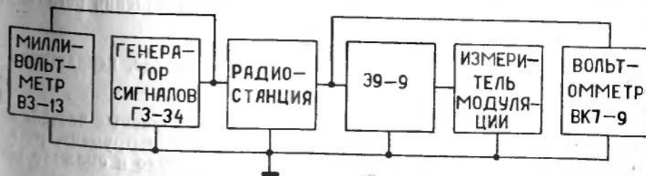
Рис. 21. Структурная схема измерения чувствительности модуляционного входа передатчика.
