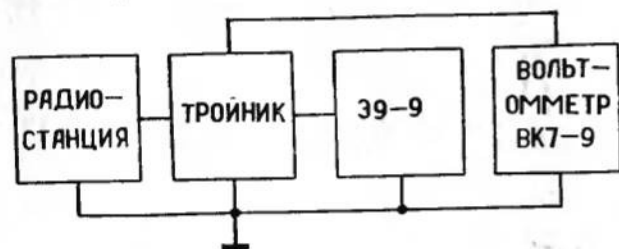
Рис. 18. Структурная схема измерения выходной мощности передатчика.
