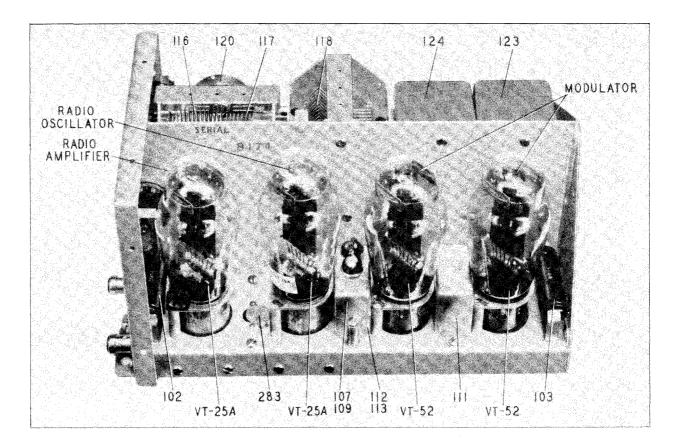
FIGURE 15—RADIO TRANSMITTER BC-AS-230, SIDE VIEW
