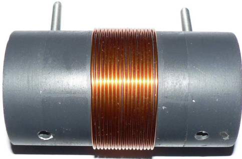
Trappe 7MHz 40m Tube Ø 40mm long 76.5mm fils Ø 1.2mm 18 spires( long 1 spire= 129.433) long avec boucles de chaque coté=2.329metre
