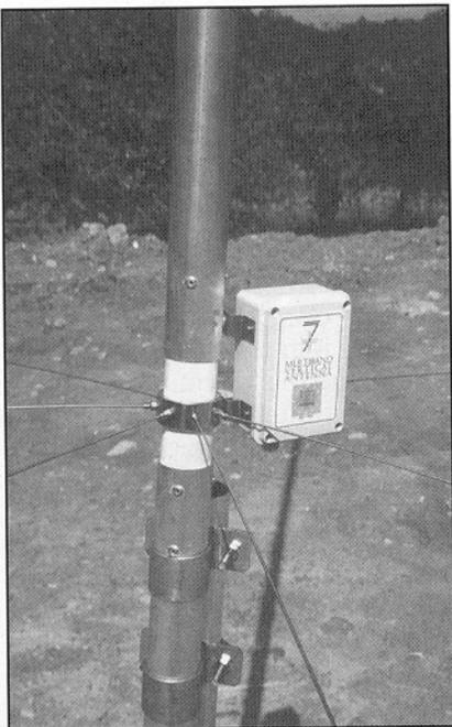
ficcate tramite il ROSmetro incorporato nell'apparato e trovate corrispondenti; nei casi necessari si è impiegato l'accordatore automatico interno onde consentire la massima erogazione di potenza; l'intervento dell'accordatore serve unicamente a tacitare il circuito di protezione in quanto l'efficienza di irradiazione dell'antenna non ne è minimamente influenzata.
