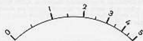
Fig. 6. Type de graduation, non linéaire, obtenue avec la disposition de la fig. 5.
