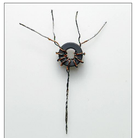
Bild 10: Fertig gewickelter Übertrager Ü2 mit verzinnenden Anschlüssen
