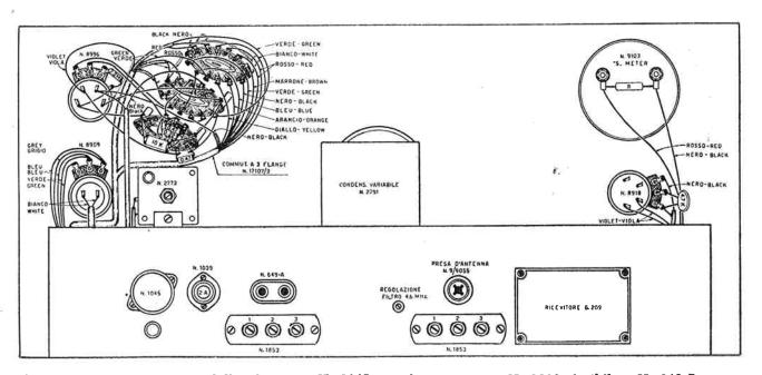
G 209-R - Vista posteriore dello chassis - N. 1045: cambio tensioni - N. 1039: fusibile - N. 649-A: presa per l'attacco del comando « stand-by » - N. 1853 (di sinistra): attacco per l'altoparlante (term. 1-2 = 3.2 ohm; 1-3 = 500 ohm) - N. 1853 (di destra): attacco per l'antenna (linea non schermata; vedi schema elettrico).
