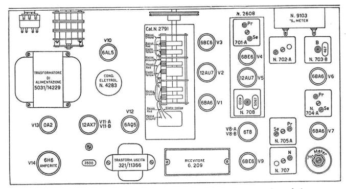
G 209-R - Posizione sullo chassis delle valvole, degli altri componenti e delle viti di regolazione.
