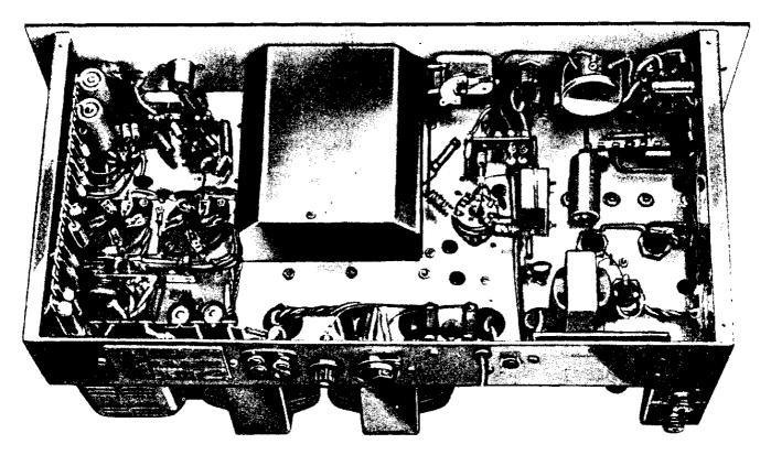
G 222 – Vista delle prese posteriori e degli organi e collegamenti posti sotto al telaio. Sono visibili: la morsettiera per l'attacco del tasto telegrafico (alle viti 3-4) e del circuito di comando «stand-by » (alle viti 1-2) il fusibile (tarato 3 A); il cambio tensioni; la vite per l'attacco della presa di terra; e a destra gli attacchi per l'antenna.
