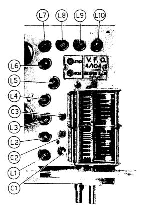
Fig. 1 — Posizione dei «trimmers » « delle induttanzo regolabili, per l'allineamenio del VFO. - Location of trimmer condensors and adjustable inductancos.
