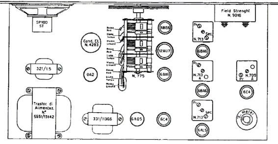
Disposizione delle parti sullo chassis. Location of main components.
