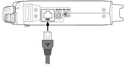
**Nota:** No es necesario desconectar el micrófono durante la explotación en el modo “Digital” o de “Paquete”, debido a que la activación de la línea del **PTT** a partir del conector de **DATOS** elimina automáticamente la entrada de audio proveniente del enchufe **MIC**.
