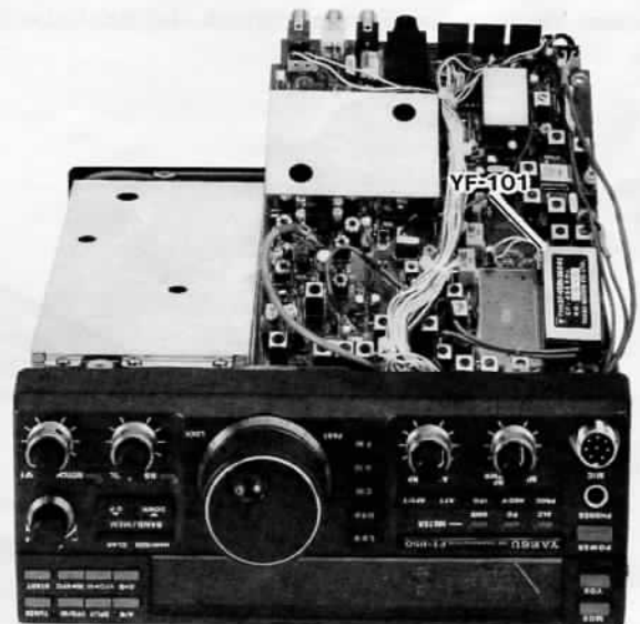
Position des SSB-Quarzfilters YF-101 (Ersatz für das Keramikfilter)
