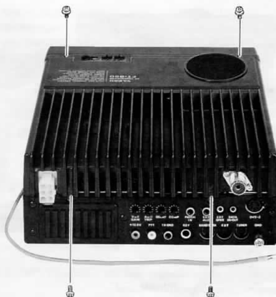
Abbildung 4: Diese vier Schrauben für das Abnehmen der oberen Gehäuseschale lösen
