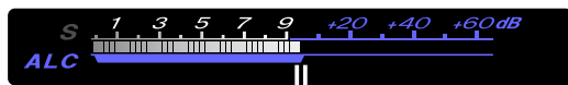
ALCがこの範囲を超えないように マイクゲインを調節してください
