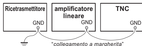
CONNESSIONE DI MASSA IMPROPRIA
