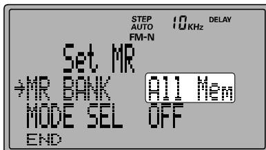
Se al passo (3) “MR BANK” impostare “In BANK”, il ricevitore ritorna sull'impostazione iniziale che richiama i canali della memoria per banchi selezionati tramite i tasti [**▼(◀)**/**▲(▶)**].
