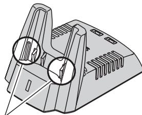
Alinee las ranuras del bloque de pilas con las guías del receptáculo pertenecientes al cargador de sobremesa **CD-30**.
