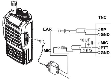
No se olvide de apagar el transceptor y el controlador TNC antes de conectar los cables, de modo de evitar que puntas de tensión dañen el aparato. Asegúrese de desconectar también el Economizador de Batería del Receptor, de haber sido activado con anterioridad (refiérase a la página 12 del manual).
