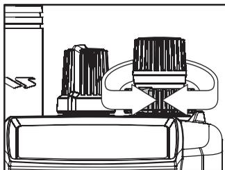
Ajuste el control de silenciamiento “**SQL**” en el punto donde justo se suprime el ruido de fondo y se apaga la luz verde del indicador LED. Si desplaza dicho control a la derecha más allá de esa regulación, reducirá la sensibilidad del equipo para captar señales débiles. Entonces, todas las veces que el receptor capte una señal que sea lo bastante intensa para abrir el circuito de silenciamiento, se encenderá la luz verde del indicador correspondiente.
