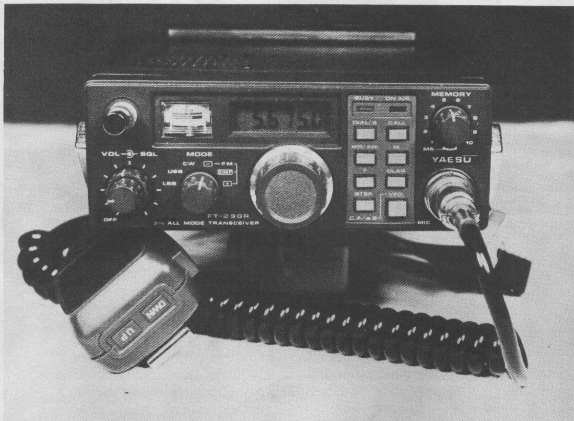
FT-290R programmato per il traffico oltre R3. Si notino i tasti «UP/DWN» posti sul microfono, utilissimi per dei QSY veloci lungo la banda.
