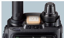
Posizione dell'antenna GPS ad alta precisione
