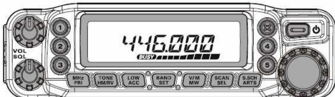
O **FT-7800R** é um transceptor FM robusto de Banda Dupla e alta qualidade. Sua potência de saída é de 50 Watts na banda Amadora de 144 MHz, e 40 Watts na banda Amadora de 430 MHz.
