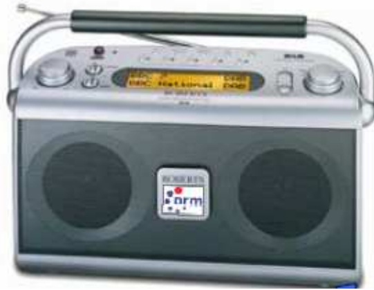
Rys. 10.49. Odbiornik cyfrowy DRM / DAB oparty na module RS500
