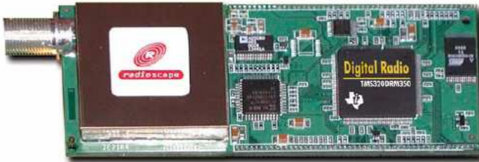
Rys. 10.46. Moduł Digital Radio Mondiale / DAB RS500 z układem scalonym TMS320DRM300/350
