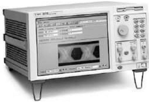
Rys. 11.16. Oscyloskopowy skaner wykresu okowego i wykres okowy (Eye Diagram) pomiaru "jitter". Kolorem niebieskim pokazano spektrum częstotliwości przebiegu.
