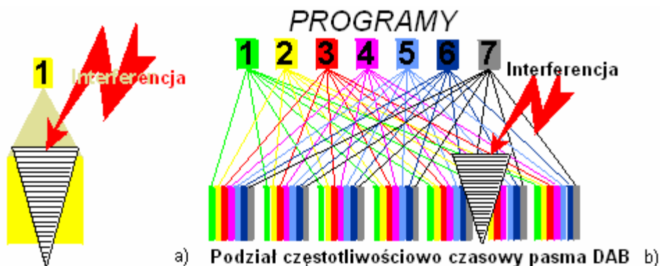
Rys. 10.8. Porównanie sposobów emisji a) tradycyjnego z podziałem częstotliwościowym zakresu i b) z podziałem częstotliwościowo – czasowym
