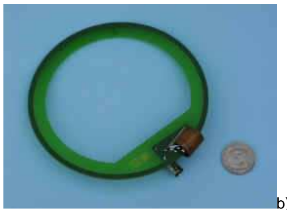
Rys. 11.3. Antena sztuczna na zakresy AM i FM do przenośnych odbiorników radiowych z anteną ferrytową i anteną prętową. Zasada działania (a) i wygląd (b)
