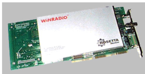
Rys. 10.63. Odbiornik radiowy WR-3700i DSP (w wykonaniu wewnętrznym, z procesorem DSP).
