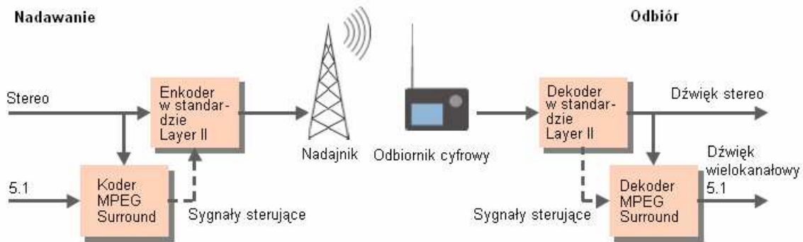
Rys. 10.52. Uproszczony schemat nadajnika i odbiornika radiowego w systemie MPEG Surround.
