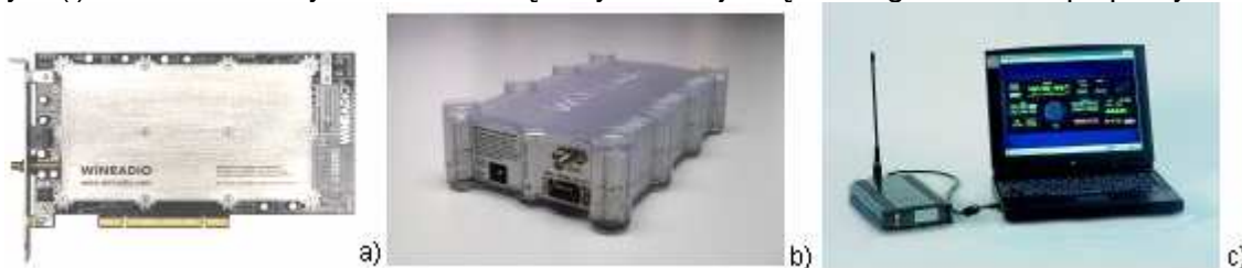
Rys. 10.62. Odbiornik radiowy WR-G313 w wykonaniu wewnętrznym (a), zewnętrznym (b) i podłączenie odbiornika zewnętrznego do laptopa przez złącze USB.
