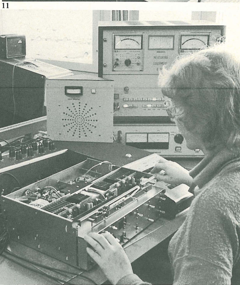
11 An speziellen Plätzen erfolgt das Einmessen und die Überprüfung von mehr als 150 Funktionen und Messwerten
