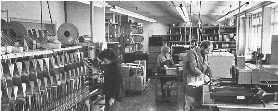
Die früher im Werk Bonndorf beheimatete "Automatische Bestückung" wurde aus transporttechnischen Gründen nach Löffingen verlagert. Ein Sequenzer und drei Bestückungsmaschinen erfüllen den Saal im Zweischichtbetrieb mit Leben.
