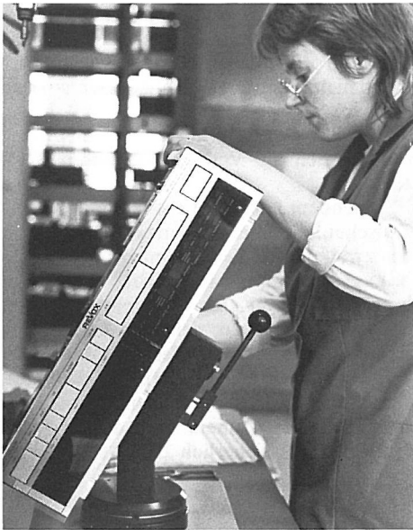
Der bereits eingemessene Verstärker auf dem Drehgestell. Fräulein Pangritz bringt die Verkleidung an bevor das Gerät an die Qualitätskontrolle abgeliefert wird.
