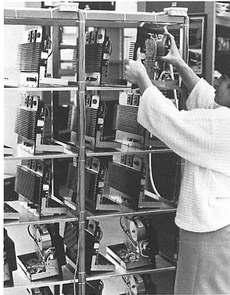
Power Cube heisst die neueste Aktivbox. Frau Günes baut den zugehörigen Verstärker zusammen. Ist der Wagen voll, wird er in die Dauerlaufkabine gefahren.
