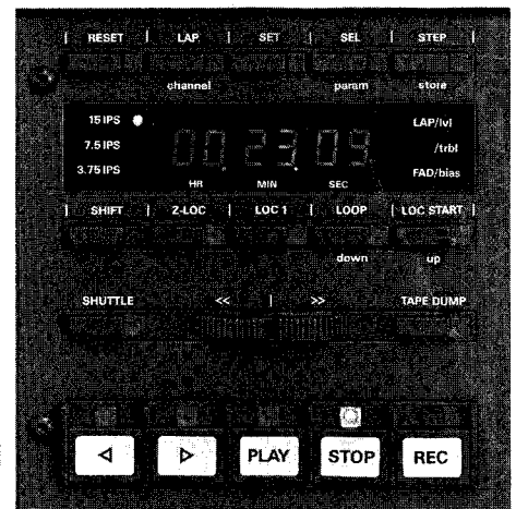
Multifunktional: Bandzählwerk und Laufwerkfunktionen.
