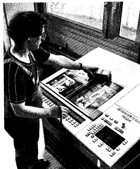
Steuerstand: CPC-Steuerstand zum Steuern und Speichern wichtiger Maschinenparameter wie Farbmenge und -zonen oder Passer (Deckungsgenauigkeit der einzelnen Farben).
