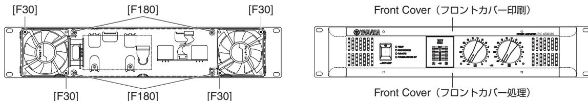
[F30]: Bind Head Screw 4.0X30 MFZN2BL (VT229100) + バインド小ネジ
