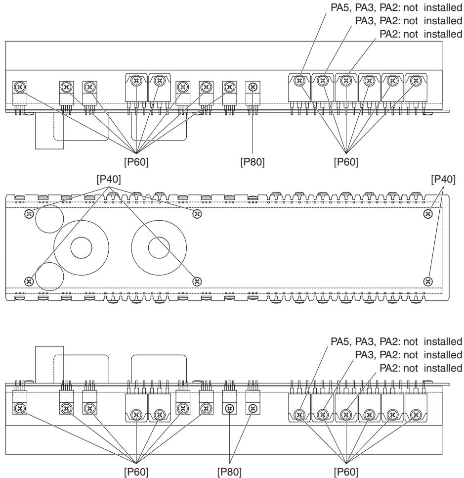
[P40]: Bind Head Screw 3.0X6 MFZN2BL (EG330360) + バインド小ネジ
