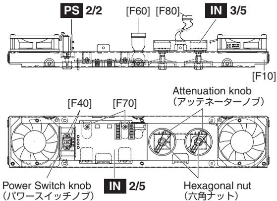
[F40]: Bind Head Screw 3.0X6 MFZN2BL (EG330360) + バインド小ネジ
