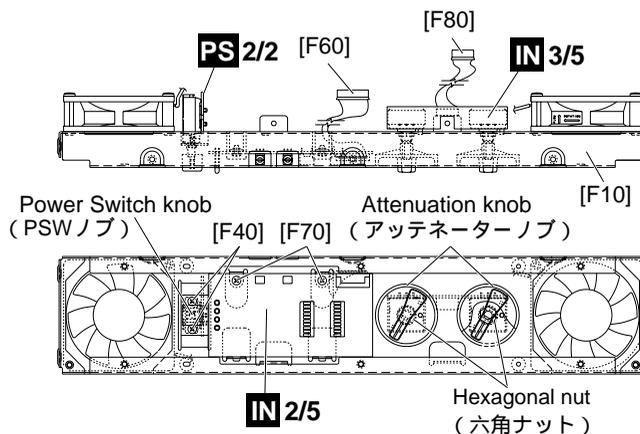
[F40]: Bind Head Screw 3.0X6 MFZN2BL (EG330360) + バインド小ネジ
