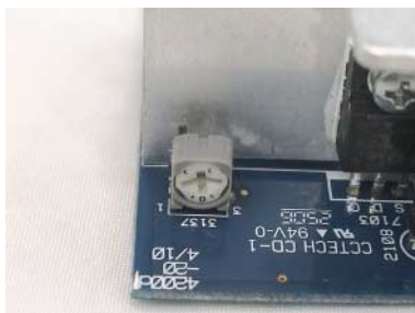
Part of the trimmer potentiometer (半固定ポリウムの部分)
