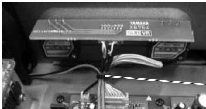
Bundle by cord holder. (インシュロックタイで束ねます。) (WD359600, WF873000, Fan wiring)
