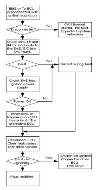
7.1.1.18 Fault code 18 – CAN message DKI fault (Throttle angle)
