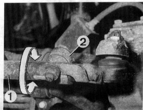
Réglage du parallélisme 1. Barre d'accouplement - 2. Collier de fixation.
