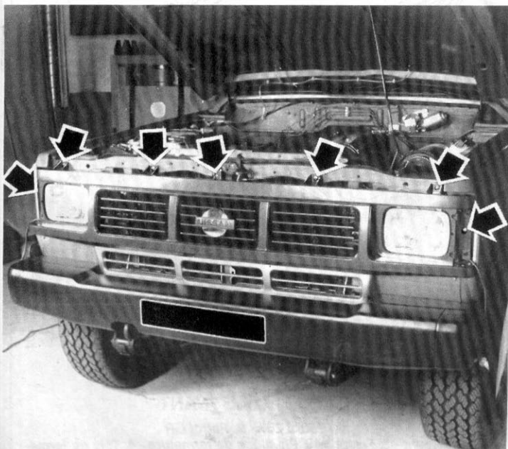
Clips de fixation de la grille de calandre de Patrol 260
