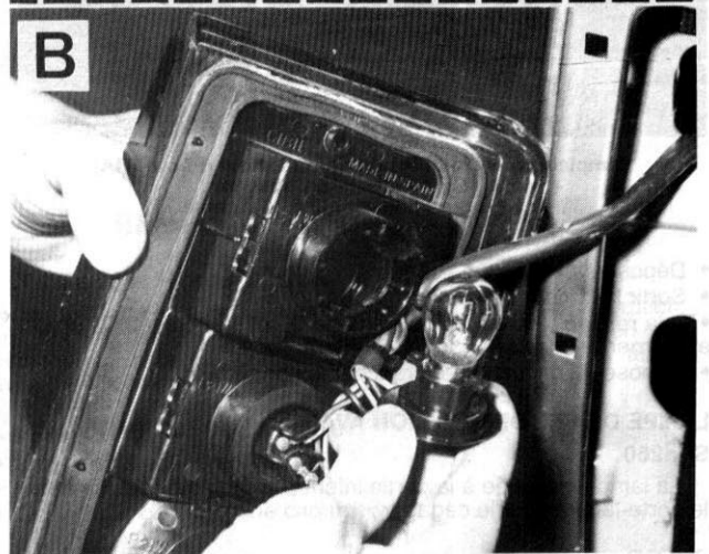
Remplacement des lampes de feux arrière sur 260 (Photos RTA) A. V : Emplacement de la vis de maintien du boîtier - B. Dépose d'une lampe.
