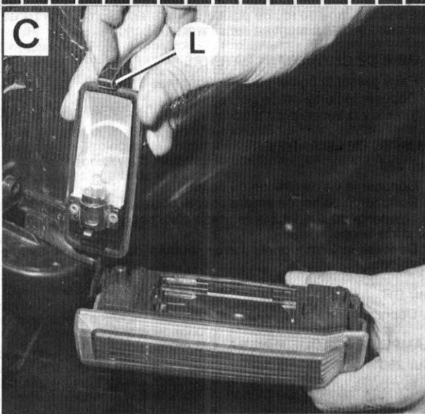
Remplacement d'une lampe de clignotant sur 260 (Photo RTA) A. Dépose du boîtier de clignotant - V. Vis de maintien - B. Dépose du porte-lampe - C. Porte-lampe déposé - L. Languette de maintien du porte-lampe dans le boîtier.
