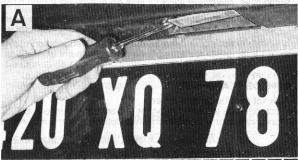
Remplacement des lampes de feux arrière sur (GR) (Photos RTA) A. Feux en bas d'ailes - V. Vis de maintien du transparent. B. Feux en bout d'ailes - C. Feux sur pare-chocs - V. Vis de maintien du transparent. D. Feux sur pare-chocs.
