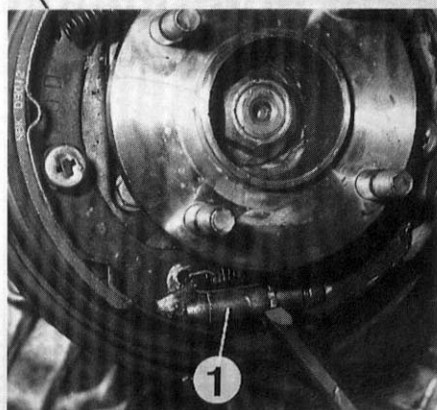
Dérèglage du frein de stationnement (Patrol GR)
