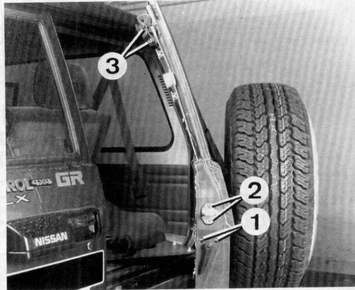
Dépose du système d'ouverture de porte arrière droite de Patrol GR 1. Vis de fixation de la poignée - 2. Vis de fixation de la gâche - 3. Vis de fixation de la serrure.
