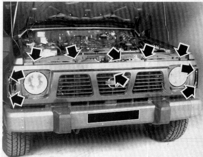
Clips de fixation de la grille calandre de Patrol GR
