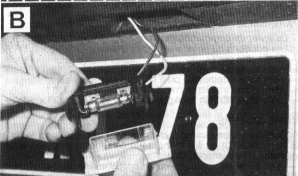
Remplacement de la lampe de plaque minéralogique sur 260 (Photo RTA) A. Déclipage du transparent - B. Dégagement du porte-lampe.
