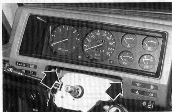
Vis de fixation de la casquette du combiné d'instruments (Patrol 260).
