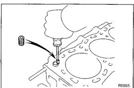
9. REMOVE CYLINDER BLOCK ORIFICE
