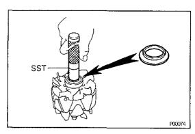
(d) Using SST, push in the bearing cover. SST 09285-76010
