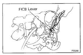
(d) Adjust by bending the FICB lever.
