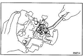
3. INSTALL FAST IDLE CAM
