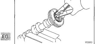
(d) Using snap ring pliers, remove the snap ring.
