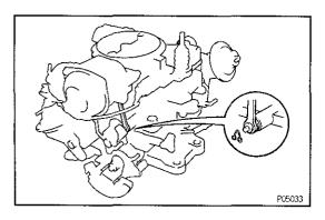
3. DISCONNECT FAST IDLE CAM BREAKER (FICB) LINK
