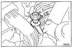
e) Torque the lock nut.
