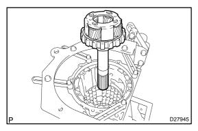
(d) Install the rear planetary gear assy.
