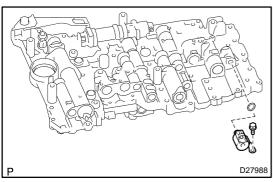
9. INSTALL SHIFT SOLENOID VALVE S2
