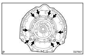
8. REMOVE AUTOMATIC TRANSMISSION HOUSING
