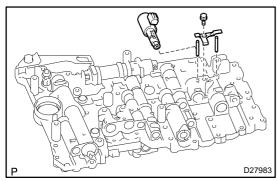
14. INSTALL SHIFT SOLENOID VALVE SLU
