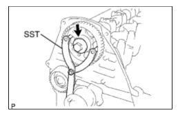
(b) Using SST, loosen the pulley bolt.
