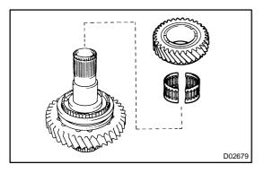
3. REMOVE FRONT TAPER ROLLER BEARING
