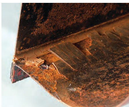
Ausgestiegen: Fertans neues Nanoprodukt NT10 wurde mit der falschen Düse verarbeitet
