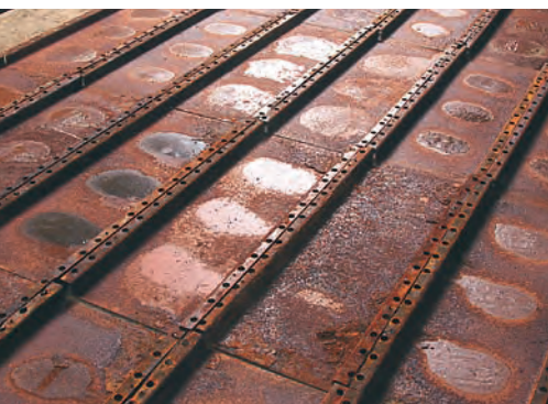
Die demontierten Deckel der Nebenkammern geben Auskunft über die Kriechfähigkeit...
