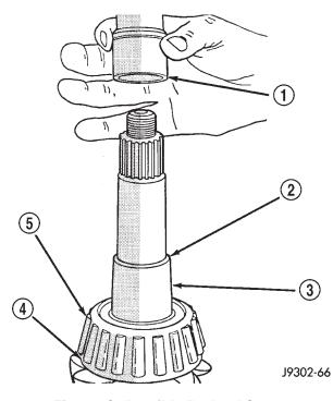
Fig. 13 Collapsible Preload Spacer
