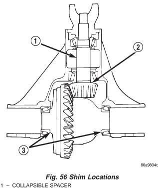
2 - DRIVE PINION GEAR DEPTH SHIM
