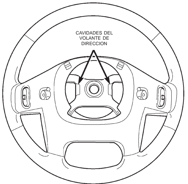
Fig. 14 Cavidades de armadura del volante de dirección
