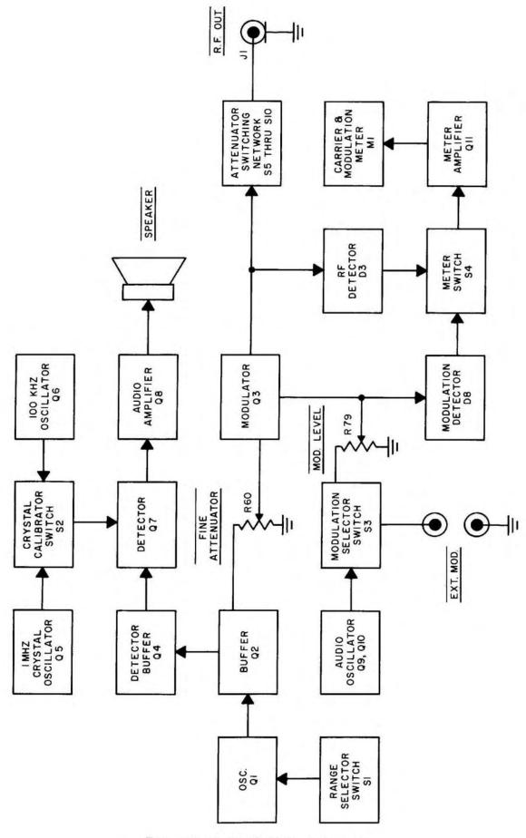
Figure 10. Model E200D Block Diagram
