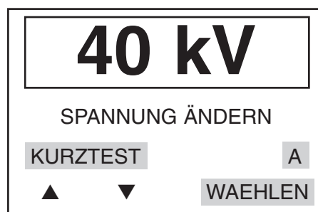
Abbildung 14 Bildschirmbeispiel: Einstellung der Spannung für einen Überlastversuch
